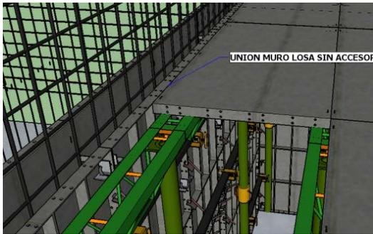
a) Unión muro-losa de 90° sin accesorio.
