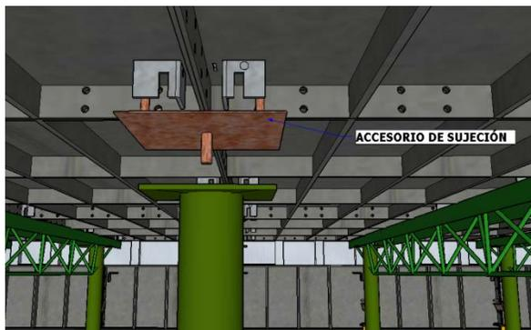
Figura 44. Accesorio de sujeción de paneles apoyado por par.
