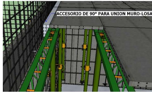
b) Unión muro-losa con accesorio.
