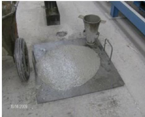
*Figura 60. Ensayo de flujo libre para concretos autocompactante.*
