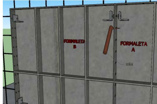
Figura 34. Utilización de la uña para alinear encofrados.
