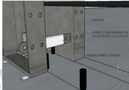
Figura 28. Colocación de corbatas.
