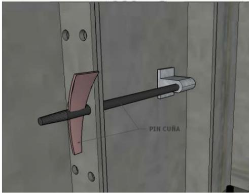
Figura 32. Fijación de paneles de encofrado: Pin Cuña.
