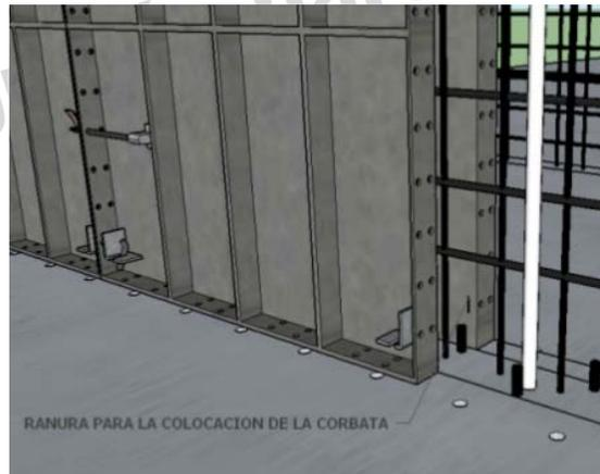
Figura 26. Encofrado sección baja de muros.
