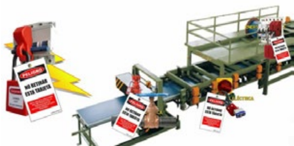
Figura 3. Bloqueo y etiquetado (LOTO / LOTOTO)
